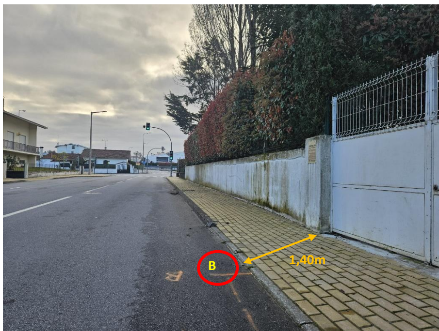
Figura 6 – ponto B, com prego e anilha, e distâncias aos pontos de referência.
