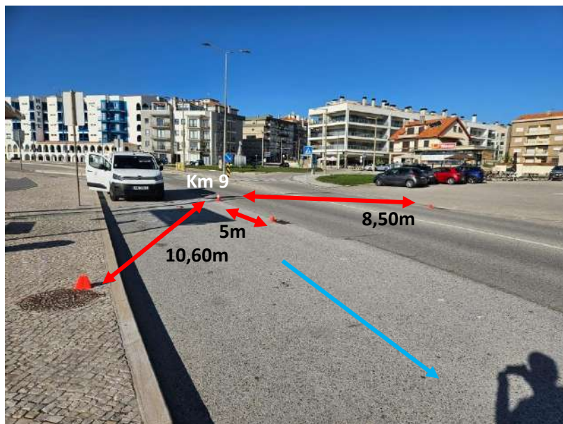
Figura 29 – km9, com prego e anilha, e distâncias aos pontos de referência (sentido do percurso a azul).
