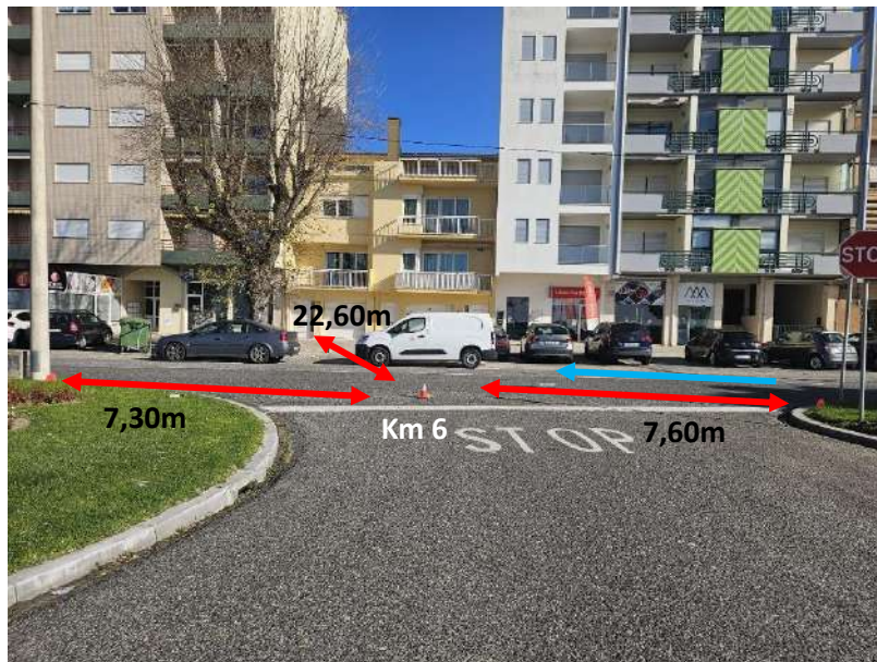
Figura 21 – km6, com prego e anilha, e distâncias aos pontos de referência (sentido do percurso a azul).
