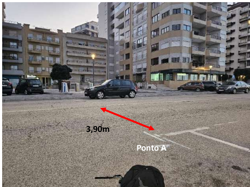
Figura 4 – ponto A, com prego e anilha, e distância ao ponto de referência.
