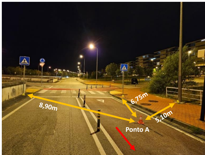
Figura 3 – Ponto A da Base de Calibração da Portela, Coimbra – 05/24, marcado com prego e anilha no asfalto (com direção marcada a vermelho, de Oeste para Este, rumo ao ponto B, 300 metros depois).
