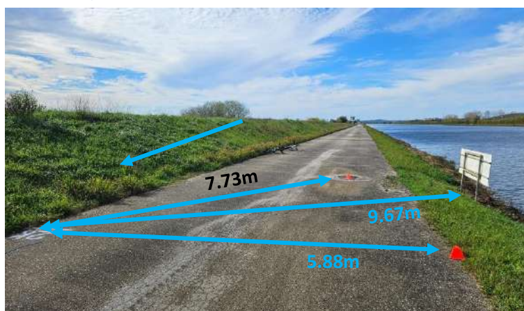
Figura 18 - 2ºkm do percurso dos 10km, marcado com prego e anilha, do lado direito do atleta, atendendo à sua direção da corrida (vista do interior do centro náutico, no sentido contrário ao da corrida).
