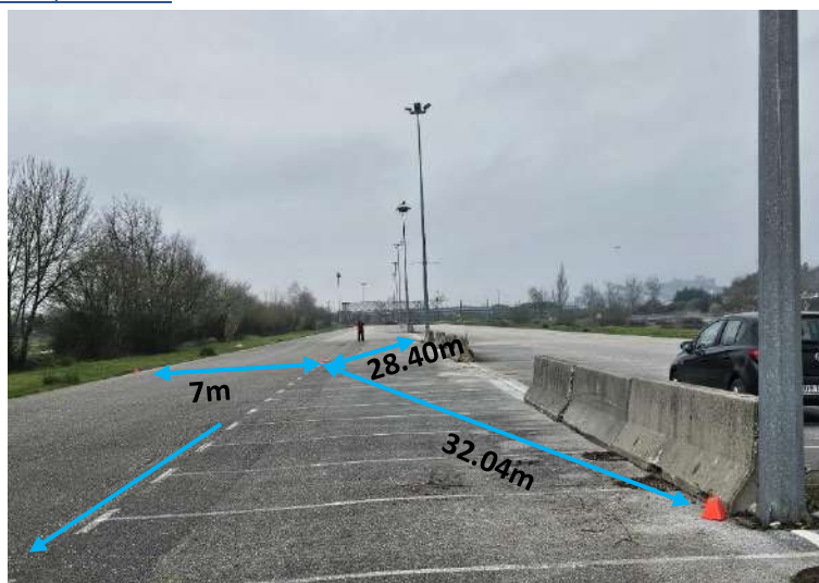
Figura 7-Ponto B da base de calibração do Centro Náutico de Montemor-O-Velho, marcado com prego e anilha no asfalto (perspetiva oeste-este).
