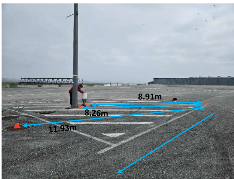
Figura 6-Ponto A da base de calibração do Centro Náutico de Montemor-O-Velho, marcado com prego e anilha no asfalto (perspetiva este-oeste).
