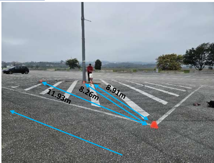
Figura 5-Ponto A da base de calibração do Centro Náutico de Montemor-O-Velho, marcado com prego e anilha no asfalto (perspetiva oeste-este).
